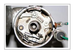
Dans la mesure où les vis platinées et les cames, sur allumeur ou magnéto avec bobine externe, sont encore dans un état convenable, il y a juste quelques fils à brancher et c'est le module qui commande l'allumage, les vis platinées ne servant plus que «d'interrupteur».
